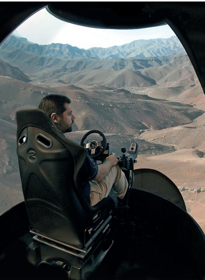
Le second bénéfice concerne le réalisme de la simulation. Elle est aussi proche que possible des opérations réelles grâce à un champ de vision de 220° conjugué à une technologie d'écran semi-rigide permettant une visualisation optimale.
